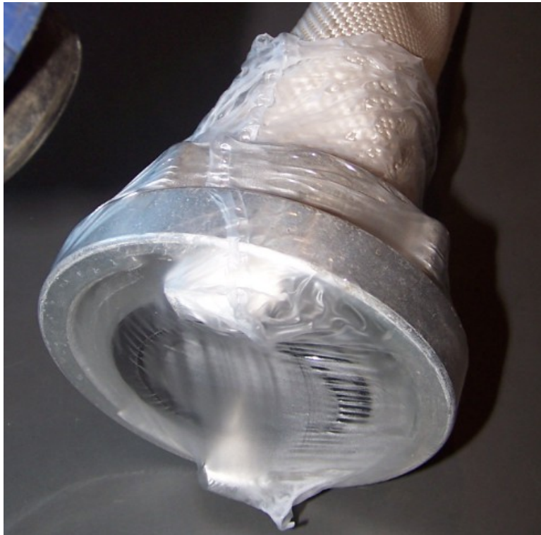
versiegelte Storz-B Kupplung an einem Bauschlauch
